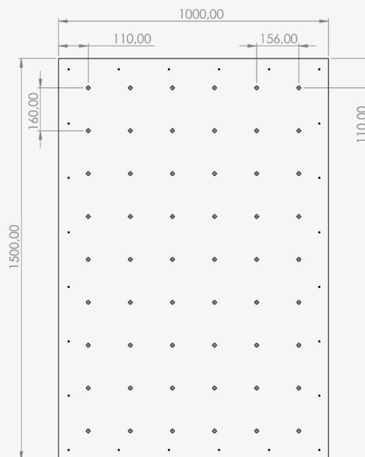
**Plan de la trame de perçage pour les panneaux 1000 x 1500**
