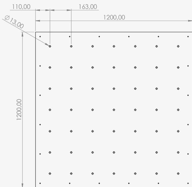
**Plan de la trame de perçage pour les panneaux 1200 x 1200**
