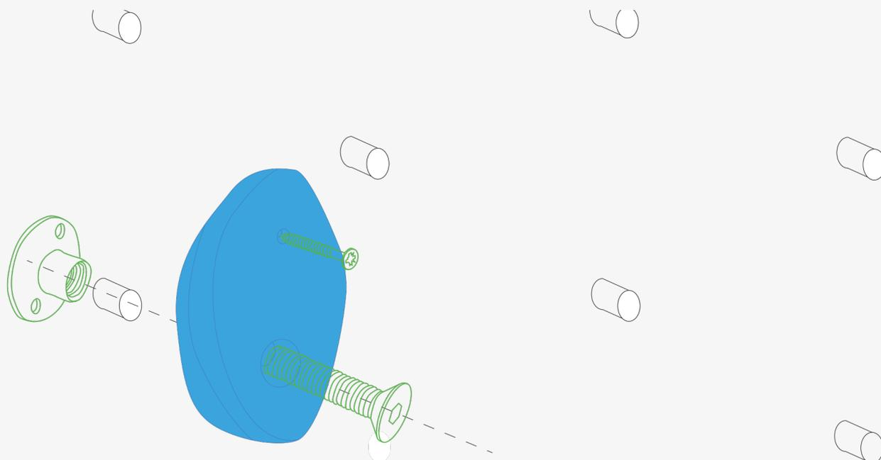
Rien de plus simple que de fixer vos prises Osm'Ose sur vos panneaux d'escalade. Les inserts accueillent les vis, CHC ou FHC. Les vis à bois permettent d'éviter la rotation des prises.
